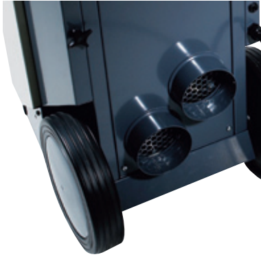
CDT 30 S und CDT 40 S sind mit einem 1 kW elektrischen Heizelement sowie einem druckstabilen Ventilator versehen. Dies ermöglicht die Montage von 2 Stck. Ø100 mm und max. 5 m langen flexiblen Schläuchen.
