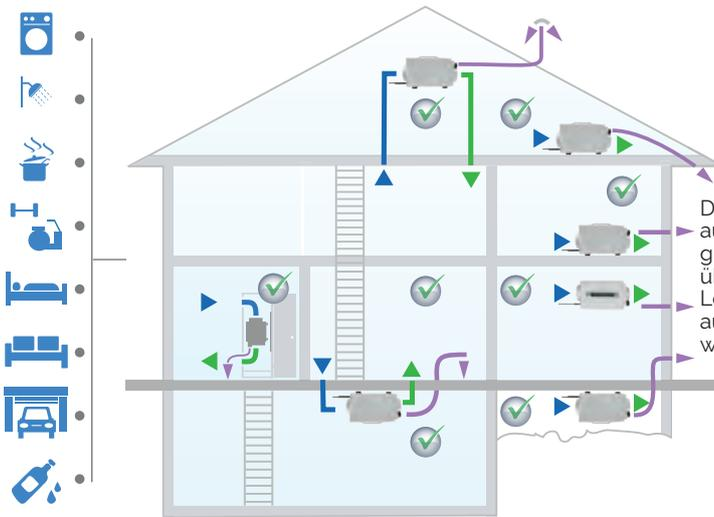
Der "Kondensat-austritt" MUSS grundsätzlich über eine Leitung nach außen geführt werden.
