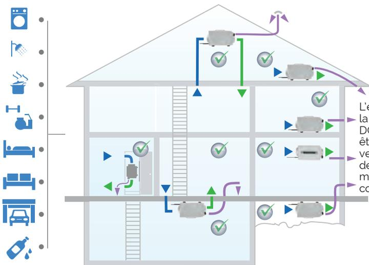
L'évacuation de la condensation DOIT toujours être acheminée vers l'extérieur de la pièce au moyen d'une conduite.
