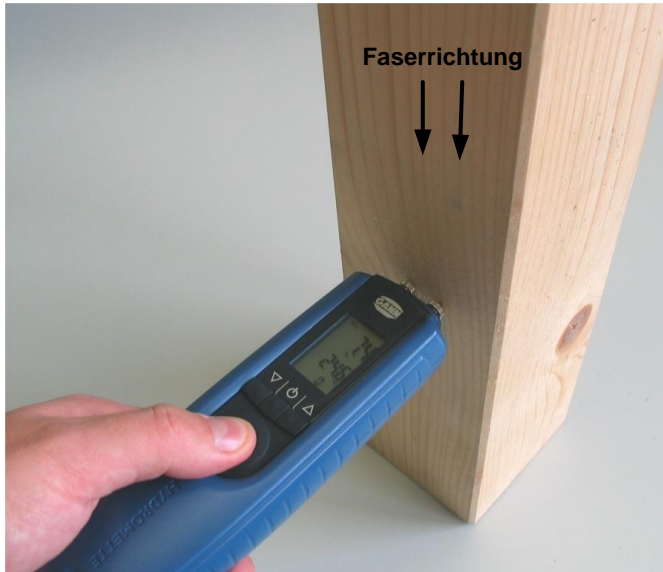
Abbildung 4-1 Messung quer zur Faserrichtung
