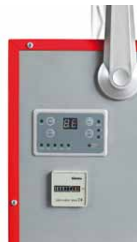
Bedienungspanel und Betriebsstundenzähler
